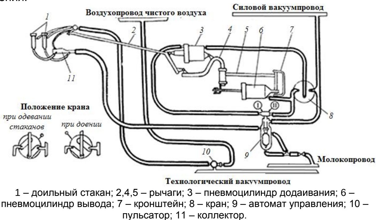
Рисунок 1 - Схема манипулятора доения МД-Ф-1
